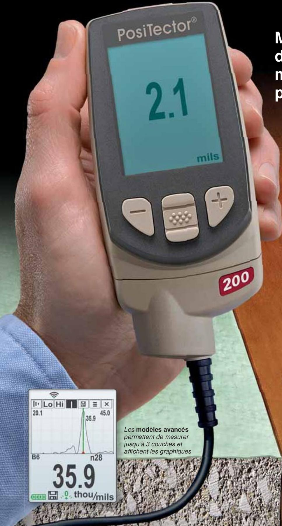
Les modèles avancés permettent de mesurer jusqu'à 3 couches et affichent les graphiques
