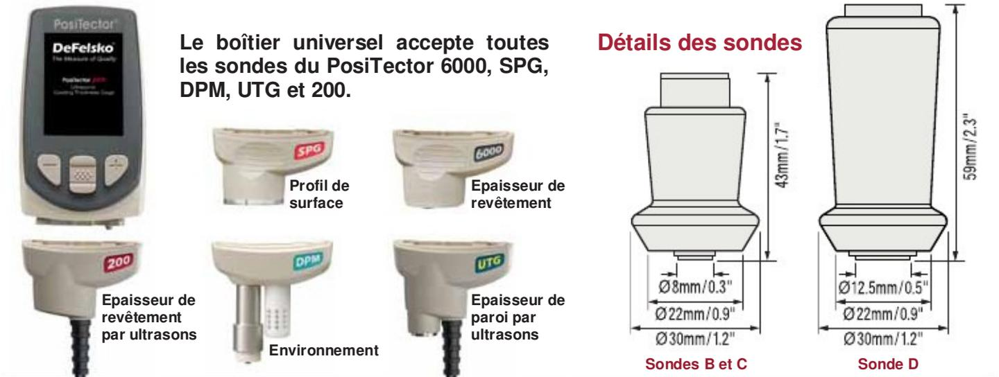
Le boîtier universel accepte toutes les sondes du PosiTector 6000, SPG, DPM, UTG et 200.
