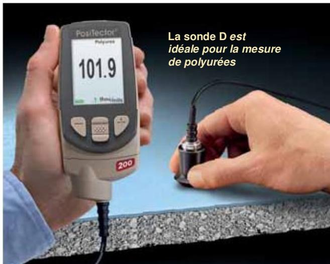
La sonde D est idéale pour la mesure de polyuréthes
